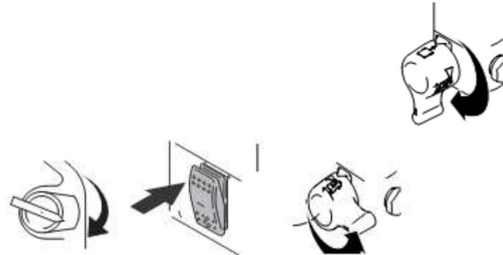
3. Переведите регулятор давления в среднее положение. Прижмите краскораспылитель к стенке ведра с материалом. Снимите предохранитель спускового механизма. Увеличивайте давление, пока двигатель не приведет в действие насос. Нажимайте на спусковой механизм краскораспылителя, пока из него не пойдет промывочная жидкость.
