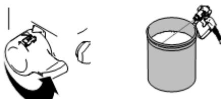
6. Поднимите сифонную трубку над уровнем промывочной жидкости и дайте распылителю поработать 15-30 секунд, чтобы слить жидкость. Выключите насос. Отключите двигатель.
