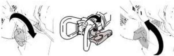
2. Наденьте предохранитель спускового механизма.. верните поворотный наконечник в первоначальное положение, снимите предохранитель спускового механизма и продолжайте распыление.
