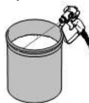
5. Опустите заливочный клапан вниз и дайте жидкости поциркулировать примерно 30 секунд, чтобы очистить сливную трубку.
