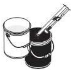
7. Закройте сливной клапан. Направьте краскораспылитель в ведро с промывочной жидкостью и нажмите на спусковой механизм, чтобы слить жидкость из шланга.
