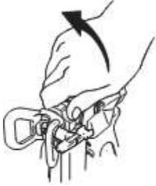
6. Разблокируйте предохранитель спускового механизма. Плотно прижмите металлическую часть краскораспылителя к стенке заземленного металлического ведра и нажмите на спусковой механизм, чтобы сбросить давление.
