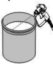
5. Опустите заливочный клапан вниз и дайте жидкости поциркулировать примерно 30 секунд, чтобы очистить сливную трубку.
