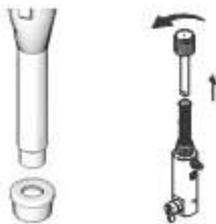
10. Заполните уплотнительную гайку горловины TSL, чтобы предотвратить преждевременный износ уплотнения. Делайте это перед каждым распылением.
