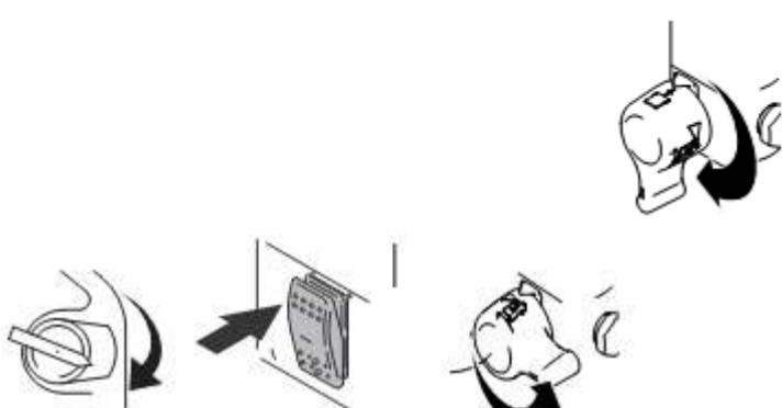
3. Переведите регулятор давления в среднее положение. Прижмите краскораспылитель к стенке ведра с материалом. Снимите предохранитель спускового механизма. Увеличивайте давление, пока двигатель не приведет в действие насос. Нажмите на спусковой механизм краскораспылителя, пока из него не пойдет промывочная жидкость.
