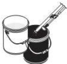
7. Закройте сливной клапан. Направьте краскораспылитель в ведро с промывочной жидкостью и нажмите на спусковой механизм, чтобы слить жидкость из шланга.
